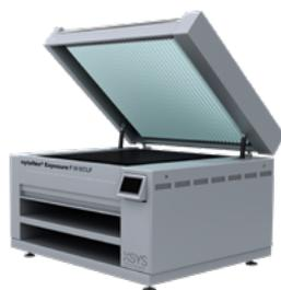
Hochwertiger Belichter für Rückseiten-, Haupt-, Nachbelichtung und Lichtnachbehandlung. Platzsparendes und kompaktes Design. Temperierung der Vakuumpalte (integriertes Temperiergerät). Digitale Anzeige zur Erfassung der Röhrenbetriebsstunden und Defektröhrenanzeige. Jeweils 24 Speicherplätze für Belichter und Lichtnachbehandler. Lange Lebensdauer der Leuchtstoffröhren durch Verwendung von elektronischen Vorschaltgeräten.
