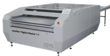
Der Durchlaufwascher ist ein vollautomatisches System mittlerer Größe zum Auswaschen, Spülen, Nachreinigen und Vortrocknen. Konstante Auswaschbedingungen durch integrierte Feststoffmessung und Temperaturregelung. Der bedienerfreundliche Touchscreen ermöglicht die automatische Anpassung von Bürstenhöhe und Auswaschgeschwindigkeit auf die jeweilige Plattendicke. Das Temperiergerät zur Regulierung der Auswaschmitteltemperatur ist im Lieferumfang enthalten.
