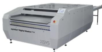
Der Durchlaufwascher ist ein vollautomatisches System zum Auswaschen, Spülen, Nachreinigen und Vortrocknen. Konstante Auswaschbedingungen durch integrierte Feststoffmessung und Temperaturregelung. Der bedienerfreundliche Touchscreen ermöglicht die automatische Anpassung der Bürstenhöhe und der Auswaschgeschwindigkeit auf die jeweilige Plattendicke. Das Temperiergerät zur Regulierung der Auswaschmitteltemperatur ist im Lieferumfang enthalten.
