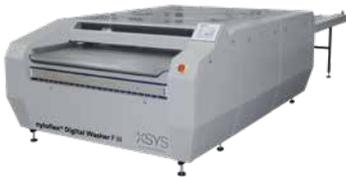
Digitaler Wascher mit flachen und runden Bürsten im mittleren Format. Ausgestattet mit einem Doppel-Tank, der es erlaubt, die schwarze Schicht der digitalen Platten aus dem Auswaschmittel zu trennen. Automatisierte Bürstenhöhenverstellung für einen optimale Bürstendruck je nach Plattendicke. Temperaturregelung für das Auswaschmittel und integrierte Feststoffmessung.
