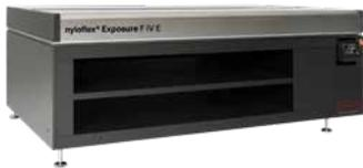
Hochwertiges Belichtungssystem, mit automatischer pneumatischer Deckelöffnung, gleichmäßige und reproduzierbare UV-Leistung, optimal für die Wiedergabe hochauflösender Raster und feinsten Bilder. Effizientes Temperaturkontrollsystem mit integriertem Kühler und Lampenlüftungssystem. Die Lampentemperatur wird automatisch angepasst. Faseroptik zur Erkennung defekter Lampen, bis zu 24 Speicherplätze für die Verarbeitungsparameter.
