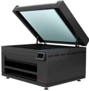
Hochwertiger Belichter und Nachbehandler in einem Gerät, mit automatischer Deckelöffnung. Kompaktes und effizientes Design. Gekühltes Belichterbett für gleichmäßige und reproduzierbare Temperaturverteilung ohne Belichtungszeiten zu beschränken. System mit einer UVA-UVC Nachbelichtung und Nachbehandlungsschublade. Luftstrom-Kühlsystem. Faseroptik zur Erkennung defekter Lampen.
