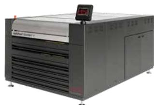
Kompaktes all-in-one Gerät mit Belichter zur Rückseiten-, Haupt- und Nachbelichtung, Batch-Wascher, Trockner und Lichtnachbehandler. Geeignet für mittel- oder kleinformatige Anwendungen. 24 Programme für Speicherung von Verarbeitungszeiten und Geräteparametern. Belichter mit Leuchtstoffröhren, gekühltes Belichterbett und Luftkühlung. Batch-Wascher mit Feststoffmessung und automatischer Lösemittelnachdosierung. Trockner mit vier individuell einstellbaren Trocknerschubladen.
