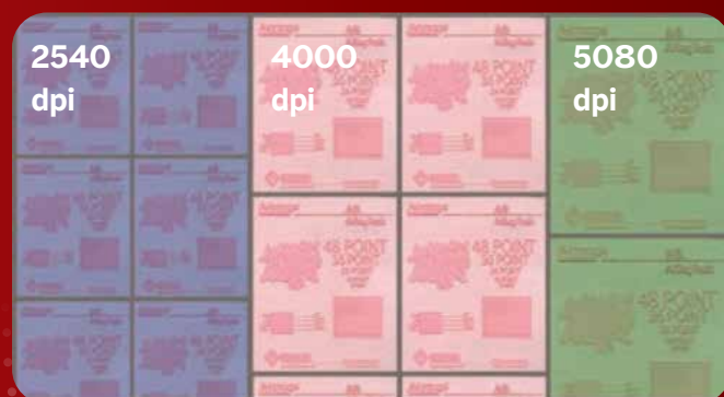
Lastra flessografica composta da più lavori a differenti risoluzioni.
