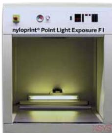
Das Tischgerät ist mit einer Metallhalogenidlampe ausgestattet und ideal für Tampondruckanwendungen. Inklusive automatischer Türen für optimalen UV-Schutz, Gelblicht zur idealen Ausleuchtung der Arbeitsplatte sowie einem Bedienfeld mit digitaler Anzeige zur bedienerfreundlichen Programmierung der Belichtungseinstellungen.
