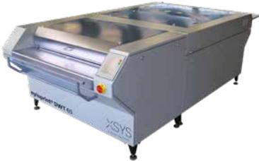
Kompaktes, tankloses Durchlaufsystem im mittleren Format zum Auswaschen, Trocknen und Nachbelichten. Ein Touchscreen vereinfacht die Bedienung; Wassertemperatur und Auswaschgeschwindigkeit werden überwacht. Das bewährte, leicht anzupassende Auswaschsystem liefert optimale Ergebnisse und beinhaltet sanfte Auswaschplüsch, eine automatisch absenkbar Abquetschwalze sowie eine Haftplatte für Folienträgerplatten und eine magnetische Haftplatte für Stahlträgerplatten.
