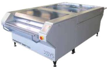
Kompaktes, tankloses Durchlaufsystem zum Auswaschen, Trocknen und Nachbelichten. Ein Touchscreen vereinfacht die Bedienung; Wassertemperatur und Auswaschgeschwindigkeit werden überwacht. Das bewährte, leicht anzupassende Auswaschsystem liefert optimale Ergebnisse und beinhaltet sanfte Auswaschplüsch, eine automatisch absenkbar Abquetschwalze sowie eine Haftplatte für Folienträgerplatten und eine magnetische Haftplatte für Stahlträgerplatten.
