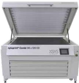
Qualitativ hochwertiger Belichter für die Haupt- und Nachbelichtung von nyloprint® Druckplatten mit integriertem Kühlgerät. Das Gerät beinhaltet vier Schubladen und 20 Programmspeicherplätze für die Haupt- und Nachbelichtung. Inklusive digitaler Anzeige zur Erfassung der Röhrenbetriebsstunden und einer Defektröhrenanzeige.
